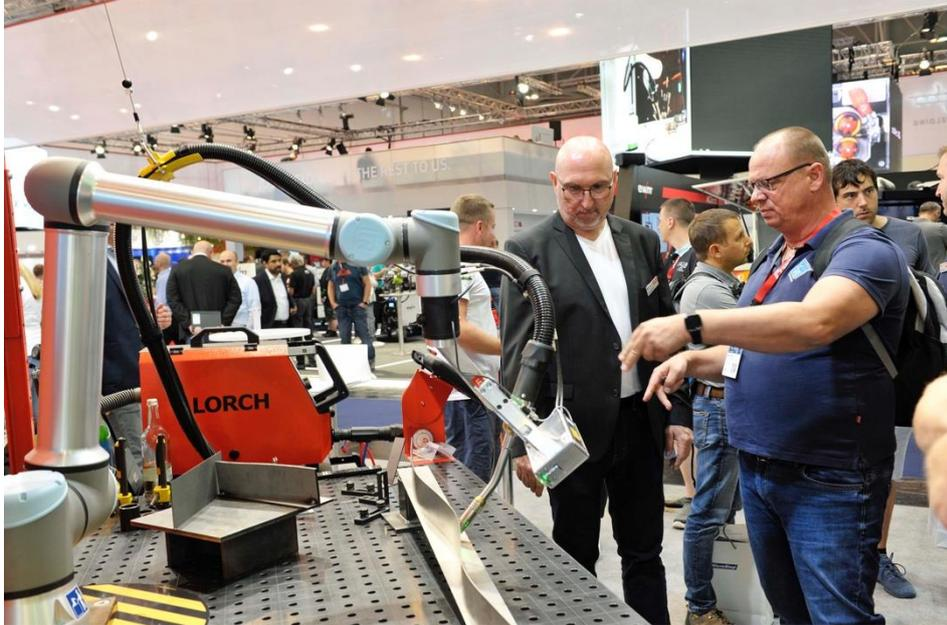
**Abb3** Weiterer Meilenstein beim Cobot-Schweißen: Dank TouchSens, SeamTracking oder SeamPilot findet der Cobot fast ohne Programmierungsaufwand die richtige Nahtposition.
