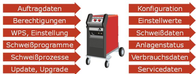
Abbildung: Datenaustausch einer Schweißanlage.
