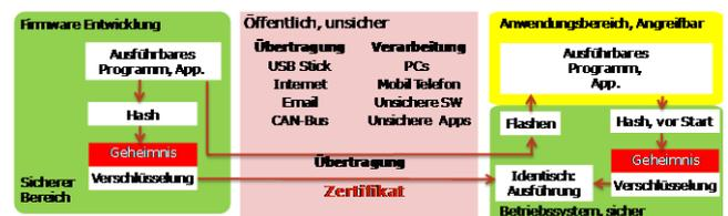
Abbildung: Firmware Verifikation und Secure-Boot.
