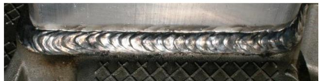
Bild 1: Bauteil: Spaltmaß (oben), MSG-Schweißnaht mit SpeedTwinPuls (unten)
