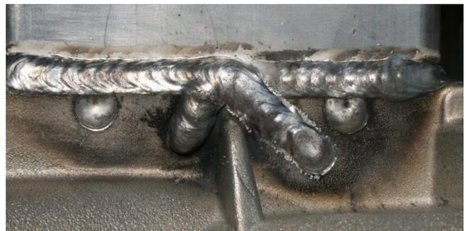
Bild 2: Nahtanfangs- und Endbereich SpeedTwinPuls (Labormontage: Heftpunkte in Bohrungen unterhalb der Naht)
