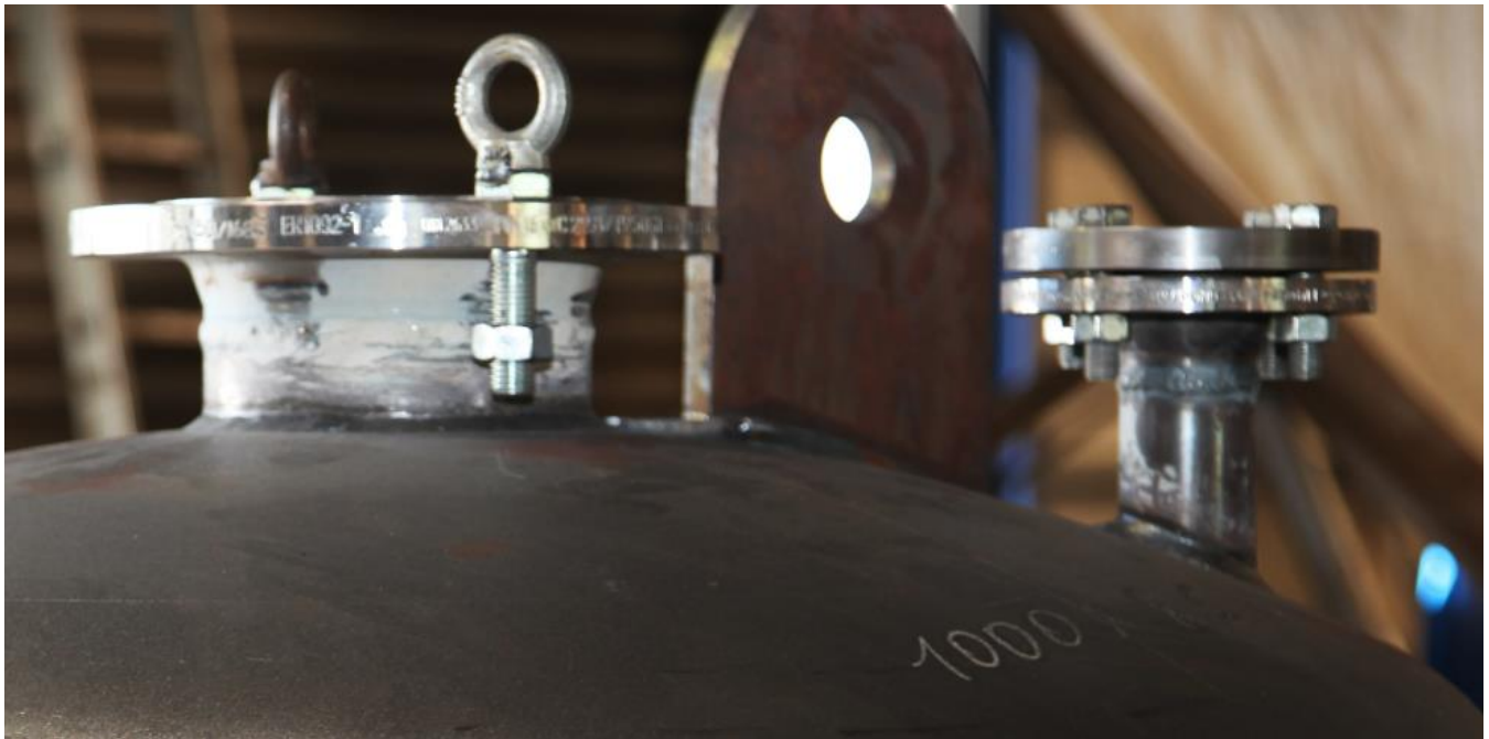
Bild 12. Einschweißte Rohrflansche an einem Behälter einer Absorptions-Trocknungsanlage
