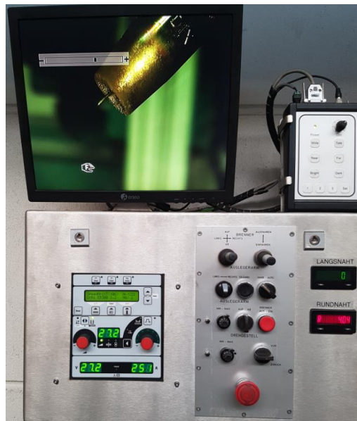
Bild 2. Zentrale Steuerung von Schweißstromquelle, Brennerpositionierung, Rollenbockdrehvorrichtung und Kamera-Prozessüberwachung
