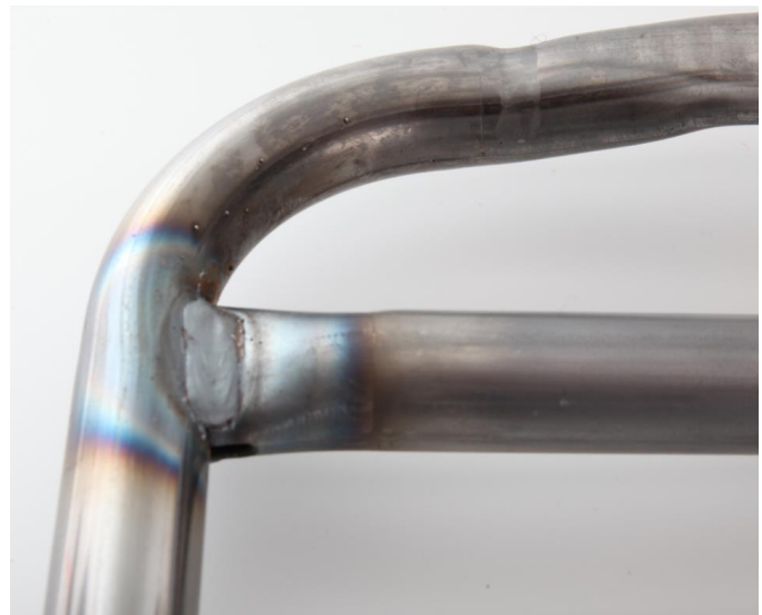
Bild 8. Rohr-Rohr-Verbindung an der Sitzgarnitur
