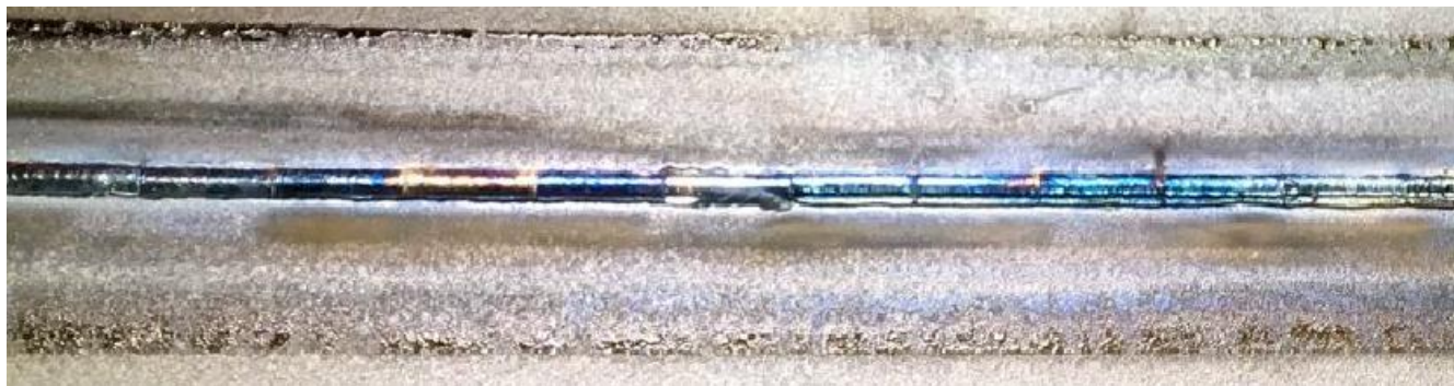
Bild 3. Ansicht der durchgeschweißten Wurzel, aufgeschmolzene Heftstelle mittig im Bild, Dicke t=6\text{mm}
