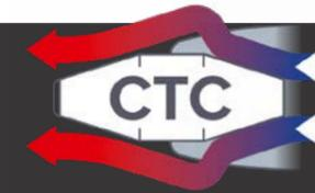
La construction spéciale du tube contact et de sa fixation améliore le transfert de courant, réduit la formation de micro-arcs électriques, garantit un refroidissement supplémentaire et réduit l'usure grâce à une charge thermique réduite.
