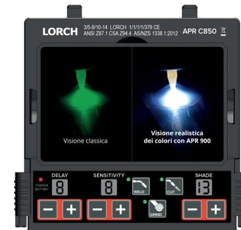
**Funzionamento e modalità:** È possibile impostare le modalità, il livello di protezione, il ritardo e la sensibilità grazie ai pulsanti indicati in modo chiaro utilizzando il display leggibile in qualsiasi momento. Durante il funzionamento è possibile selezionare la modalità saldatura (livello di protezione 10-14), la modalità molatura (livello di protezione 3) e la modalità taglio (livello di protezione 5-9).
