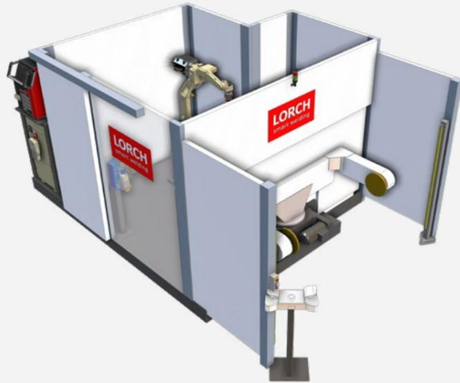
Mit der CUBE 04 erwartet sie ein wahres Multitalent. Egal ob große oder kleine Bauteile, egal ob rund oder verwinkelt. Der 180°-Horizontalpositionierer mit seinem 2-Stationen-Taktprinzip bringt ihre Bauteile in die richtige Schweißposition. OTC Schweißroboter und Positionierer arbeiten während des Schweißprozesses synchron zusammen und erledigen auf diese Weise selbst die kompliziertesten Schweißaufgaben.
