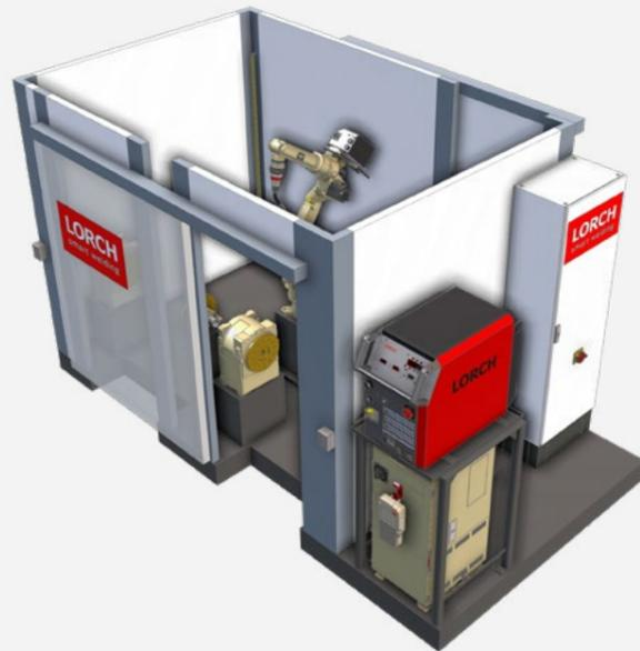
Die CUBE 03 ist ausgestattet mit einem hochpräzisen OTC Schweißroboter und zwei Horizontal-Drehpositionierern inkl. Gegenlager. Diese ermöglichen eine synchrone Umorientierung des Bauteils während des Schweißvorgangs und damit das Schweißen von runden Bauteilen oder in schwer zugänglichen Schweißpositionen. Durch ihr Zwei-Stationen-Taktprinzip sorgt sie für eine effiziente Fertigung mit optimierten Taktzeiten.
