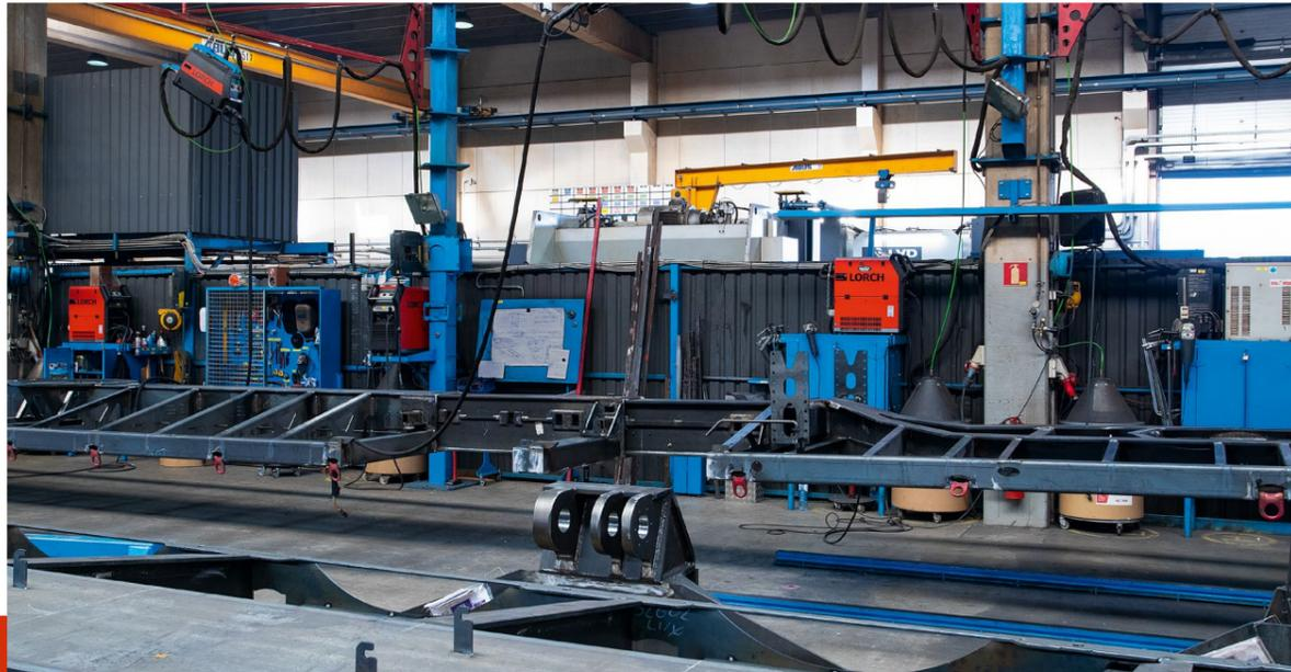
Schon über 300 MicorMIG 400 arbeiten in den fünf Werken der Faymonville Group. Der MIG-MAG Schweißinverter punktet mit dem SpeedArc-Prozess für einen fokussierten Lichtbogen, hoher Schweißgeschwindigkeit und der einfachen, mehrsprachigen Bedienführung.
