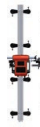
Sudare în poziție verticală cu șină de ghidaj
