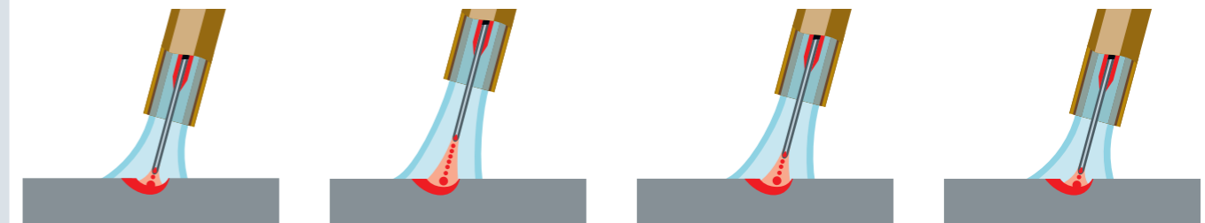
A hegesztő könnyen reagálhat a változó körülményekre a hegesztőpisztoly távolságának módosításával.
