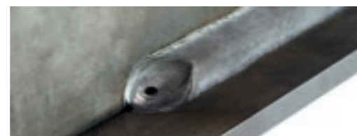
Végkráter feltöltés nélkül.
