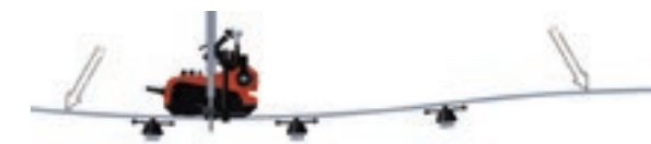
Hullámos felületen rugalmas ve- zetősínnel
