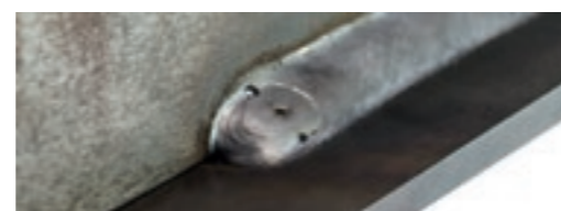
Végkráter feltöltéssel – tökéletes varratvég
