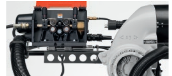
Položaj uređaja RF-06 tijekom održavanja
