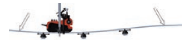
na zakrivljenoj ravni s fleksibilnom vodicom
