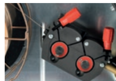
Kvalitný posun drôtu so 4 kolieskami
