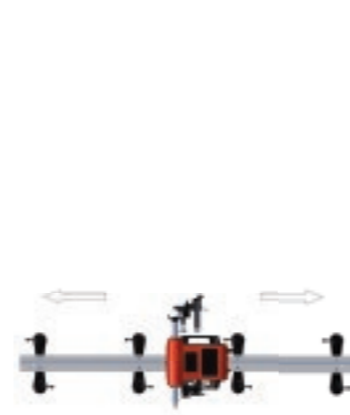
v horizontálnej polohe s vodiacou koľajou (bočné s mag- netickými držiakmi)
