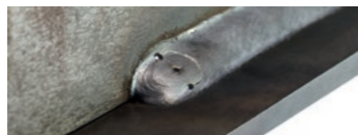
С заваркой концевых кратера – идеальное окончание шва.
