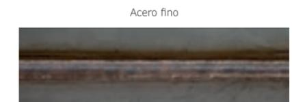
**La solución inteligente de Lorch:** El arco pulsado MicorMIG aporta menos energía al material evitando así los colores de revenido innecesarios. Con el arco pulsado MicorMIG se reducen los costosos retoques que requieren mucho tiempo, por ejemplo, para eliminar los colores de revenido. Y todo con una detección limpia de la raíz.
