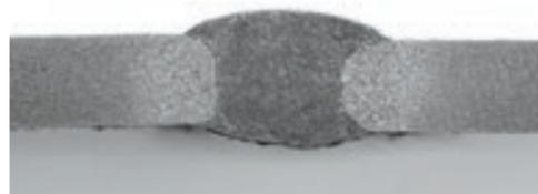
Un cordón óptimo, ligeramente abombado y sin fallos de unión, que garantiza el máximo grado de tolerancia y puenteados de grietas.
