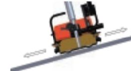
Soldadura sobre superficies inclinadas
