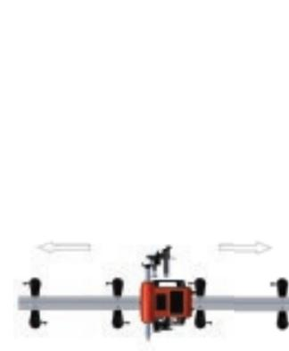
Soldadura en posición horizontal con carril guía (en lateral con soportes magnéticos)
