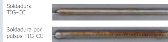
Sin inclusiones de tungsteno mediante inicio por alta frecuencia
