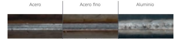
**La solución inteligente de Lorch:** No importa si desea soldar acero, acero fino o aluminio. La rápida técnica de regulación y el probado arco de luz pulsado MicorMIG proporcionan una soldadura casi sin salpicaduras incluso en el área del arco de transición, con lo que se ahorrará los retoques molestos.
