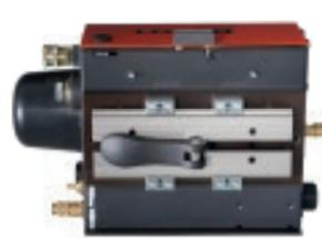
Construcción sofisticada de la base con placa aislante, canal para tender tuberías de agua y posibilidad de fijación para las distintas placas adaptadoras para robots.
