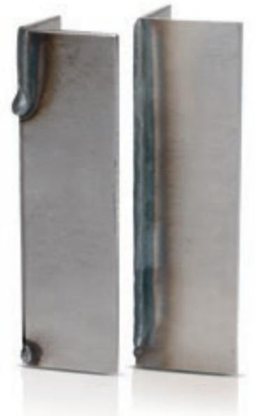
Una soldadura de esquina en comparación. Arco de luz estándar (a la izquierda): baño de fusión con avance muy rápido, justo antes de caer. SpeedCold (derecha): soldadura completa, segura y rápida (35 cm/min).
