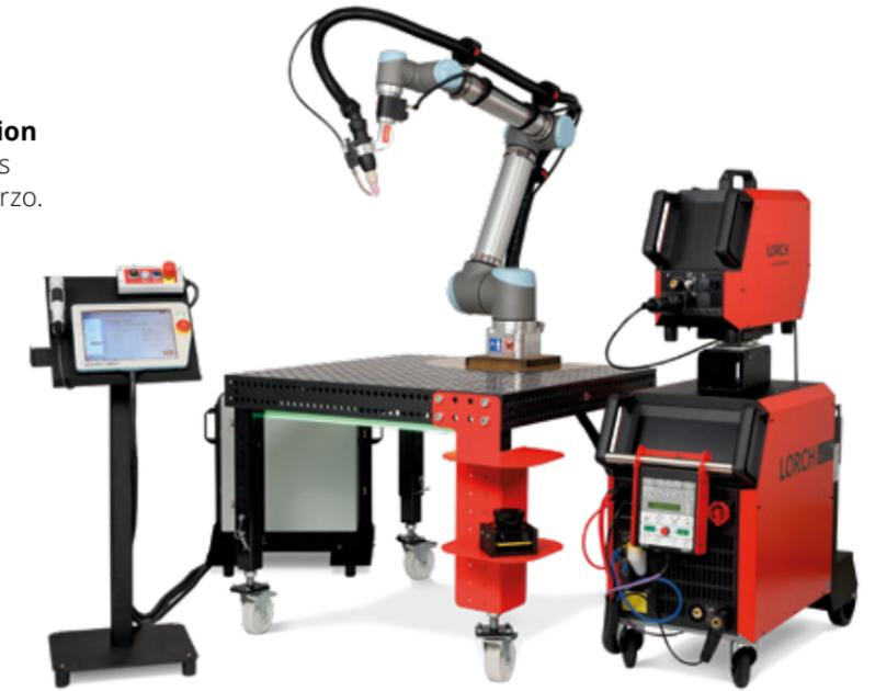
El **Lorch Cobot Welding Package TIG-Edition** permite realizar tareas de soldadura exigentes para cordones de alta calidad con poco esfuerzo.
