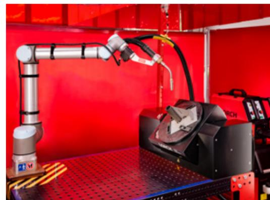
„Gracias a la soldadura con cobot, equipada con una mesa basculante y giratoria, ahoramos hasta un de tiempo 40% en las piezas de serie. Además, reducimos la carga de trabajo de nuestros soldadores, especialmente durante las tareas de soldadura prolongadas y agotadoras“
