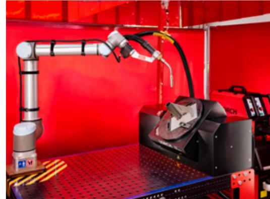
„Dank der Schweiß-Cobotlösung mit Dreh-Kipptisch erzielen wir bei Serienteilen eine massive Zeitersparnis von bis zu 40%. Zudem entlasten wir unsere Schweißer besonders bei langen, ermüdenden Schweiß Tätigkeiten.“
