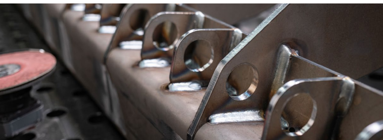
Czyste spoiny dzięki procesom spawania łukiem pulsującym – wysoka jakość produkcji jest najwyższym priorytetem w firmie Fliegl.
