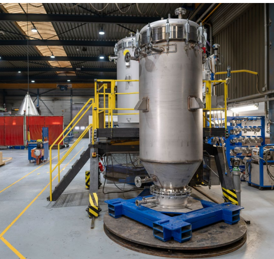
Zbiorniki ciśnieniowe osiągają średnicę do dwóch metrów i muszą wytrzymać ciśnienie do 6 barów.
