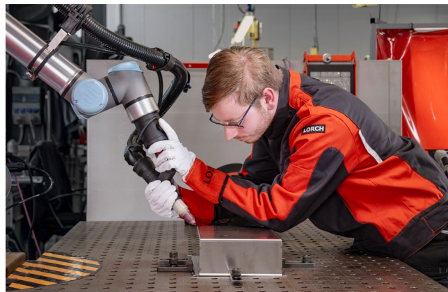
De besturing van de cobot via de Free Drive-functie direct op de lastoorts vergemakkelijkt de geleiding van de robotarm en maakt zo een exacte afstelling op het onderdeel mogelijk.
