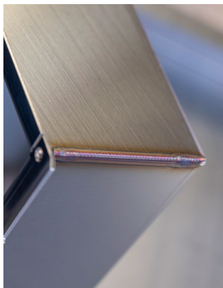
De TIG-cobot voert zelfstandig en betrouwbaar de fijnste lasnaden in roestvast staal uit.
