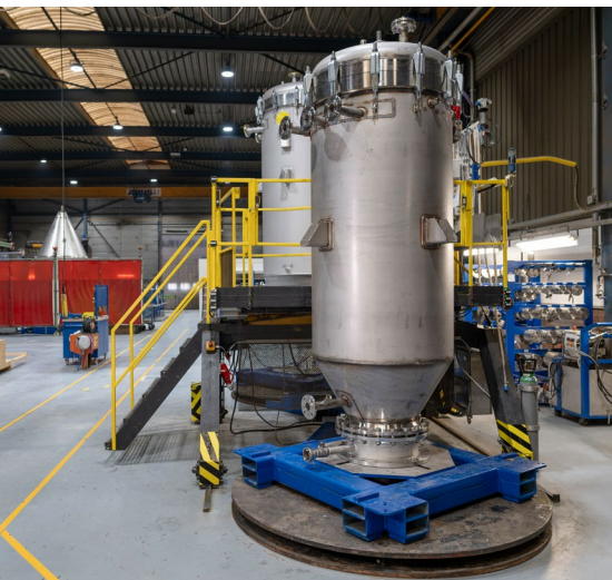
De drukvaten hebben een diameter tot twee meter en moeten deels een druk van 6 bar kunnen weerstaan.
