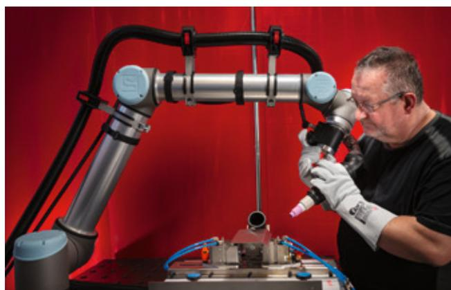
La funzione Free-Drive si trova direttamente sul portatorcia, in una posizione facilmente accessibile per il saldatore.
