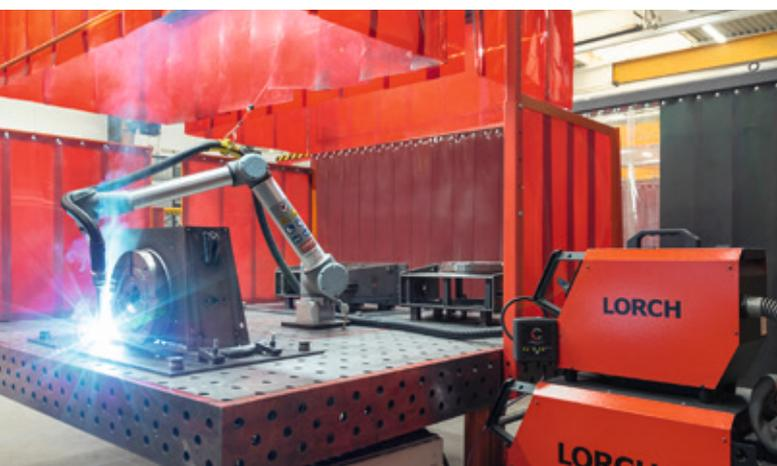
Nel campo della saldatura, tutto il parco macchine è collegato a Lorch Connect, compreso il cobot di saldatura di Lorch, utilizzato soprattutto per saldare in modo efficiente le turbine in acciaio al manganese.
