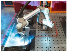
La configurazione è ottimale perché il cobot si trova tra due postazioni di lavoro standard: nell'ambito di tre sistemi di serraggio possono essere realizzate senza problemi tutte le saldature dell'alloggiamento della turbina.
