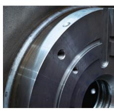
La saldatura circolare risulta perfetta perché grazie al cobot, l'anello può essere saldato al telaio della turbina con una qualità senza precedenti nonostante la complessità del telaio (acciaio al manganese).
