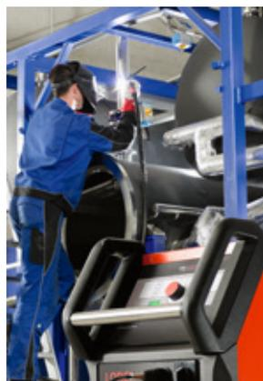
Non è più necessario correre avanti e indietro: i parametri di saldatura più importanti si possono gestire dalla torcia grazie alla sincronizzazione dati digitale anche se l'impianto non si trova nel campo visivo dell'operatore. L'illustrazione mostra T300 ACIDC, la soluzione ottimale per la produzione industriale TIG.
