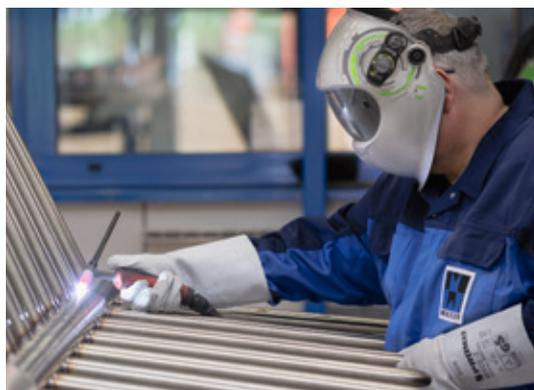
T-Pro consente di controllare l'apporto d'energia in modo assolutamente preciso: un aspetto estremamente importante per la saldatura delle lamiere sottili.
