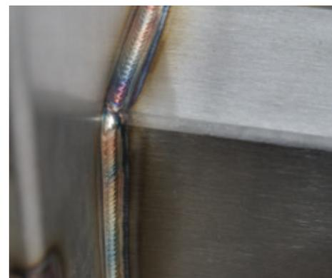
I cordoni di saldatura sono d'eccellente qualità: i cordoni di saldatura non devono presentare cavità o pori per evitare la corrosione o i microbi.
