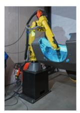
Flessibilità: l'esatta interazione del braccio del robot e del posizionatore consente di eseguire le saldature sempre nella posizione ottimale per il serbatoio.
