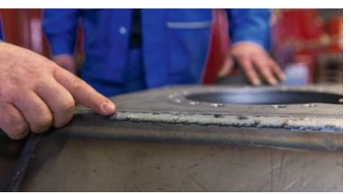
Finiture d'eccellenza, quasi prive di schizzi: grazie all'utilizzo dei robot le rifiniture per ogni cordone di saldatura sono ridotte ad un valore minimo assoluto
