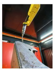
Intelligenza: grazie alla funzione Seam-Tracking, il robot individua sempre il percorso di saldatura ideale.
