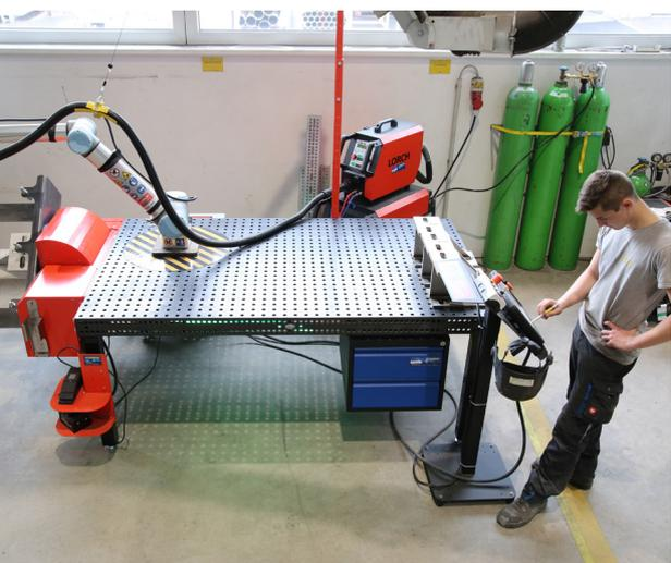
Utilizzando il nuovo robot di saldatura, Habau ottiene un enorme risparmio in termini di tempo per i pezzi in serie e allo stesso tempo riduce il carico di lavoro degli operatori.
