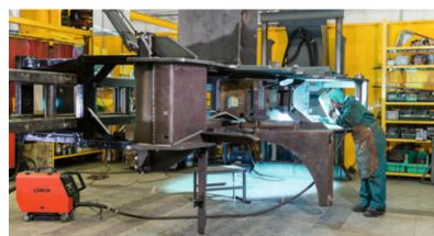
La soluzione ideale per i componenti di grandi dimensioni: grazie al telecomando Powermaster possono essere impostati i parametri di saldatura direttamente dalla torcia.
