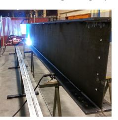
Programmazione semplice e veloce: Trac RL Pro riduce il carico di lavoro dei saldatori e garantisce eccellenti cordoni di saldatura longitudinali e curvi.
