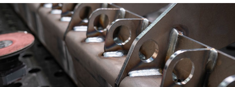
Saldature pulite grazie ai processi di saldatura pulsati: l’alta qualità della produzione è una priorità assoluta per Fliegl.
