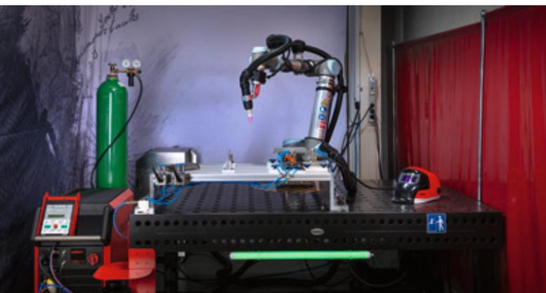
Une sécurité maximale au cours de la production en série : un système de sécurité à scanner, équipé de signaux d'avertissement sonores et visuels et d'une fonction d'arrêt d'urgence, protège l'opérateur des dangers potentiels pendant l'opération de soudage.
