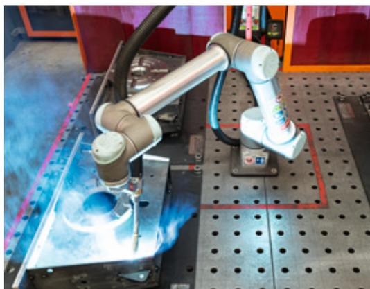
Structure optimale : le Cobot entre deux postes de travail standard – tous les cordons de soudure du carter de la turbine se réalisent facilement en trois serrages.
