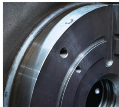
Joint circulaire parfait : grâce au Cobot, il est possible de souder le joint sur le châssis de la turbine avec une qualité encore inégalée – malgré la complexité du châssis (acier au manganèse).
