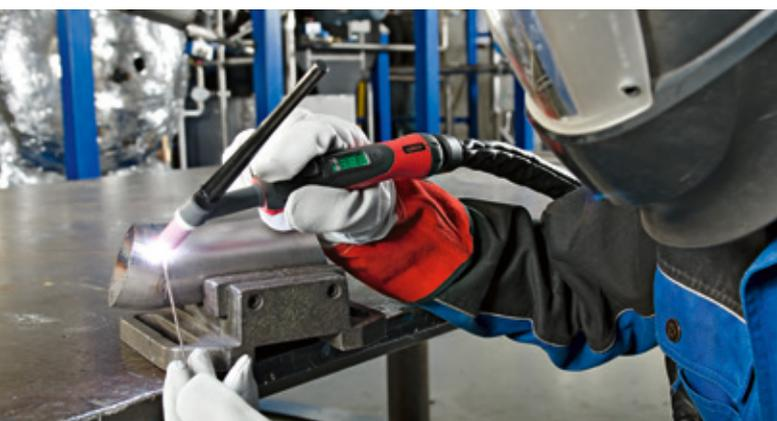
Une ergonomie parfaite : il suffit d'appuyer pendant sept secondes sur la touche Mode pour une configuration optimale de l'affichage sur l'écran, également pour les gauchers.
