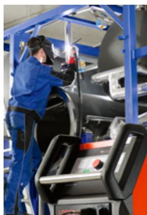
La fin des allers-retours inutiles : grâce au couplage numérique des données, les paramètres de soudage les plus importants se contrôlent à partir de la torche, même lorsque le poste n'est pas à portée de main. La photo montre le poste T300 AC/DC : optimal pour la fabrication TIG industrielle.
