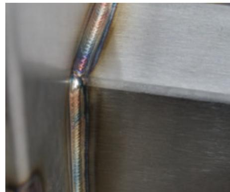
Cordons de soudure de qualité inégalée : pour ne laisser aucune chance à la corrosion et aux microbes, les cordons de soudure ne doivent présenter aucune dépression ou porosité.
