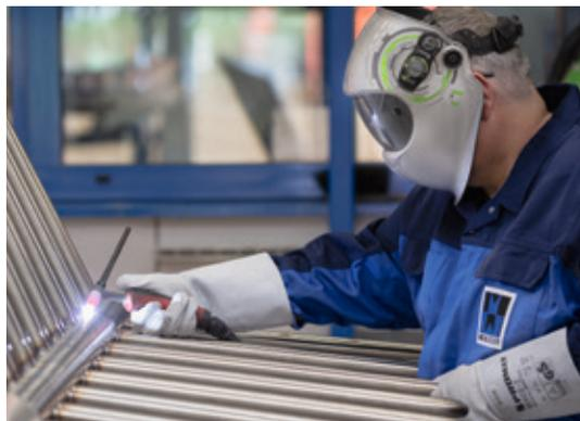
Avec le T-Pro, l'apport d'énergie se contrôle avec une précision absolue, ce qui est extrêmement important pour le soudage de tôles fines.
