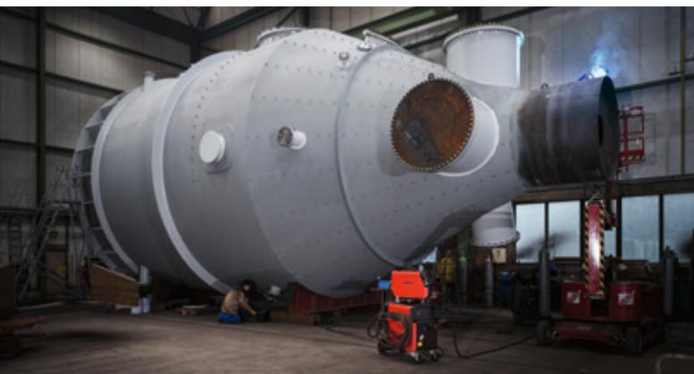
Plus de 1 000 heures sont nécessaires pour souder un évaporateur pour l'usine de dessalement. Les cordons de soudure sont soumis aux exigences les plus sévères – chaque joint droit en T est radiographié individuellement.
