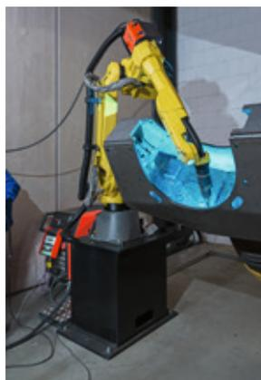
Flexible : grâce à l'interaction exacte du bras du robot et du positionneur, le soudage est toujours possible dans une position optimale de la cuve.
