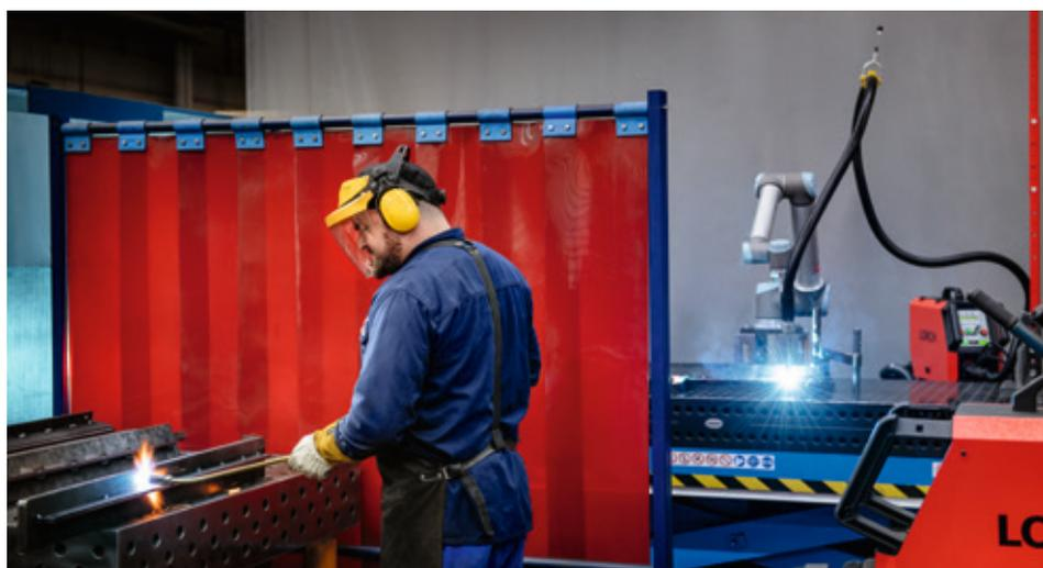
Gain de temps : pendant que le Cobot de Lorch dessine avec précision les cordons de soudure programmés d'une pièce récurrente, le soudeur prépare déjà le prochain composant à souder.
