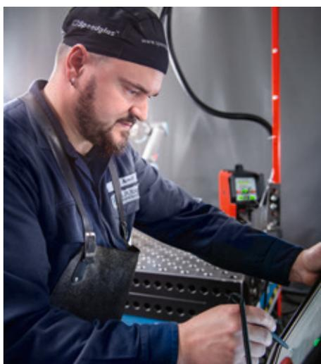
Simple : le processus de soudage « se programme » à partir de l'écran tactile. De manière alternative, il est également possible de déplacer manuellement la torche en position de départ et de fin grâce à la fonction Free Drive.
