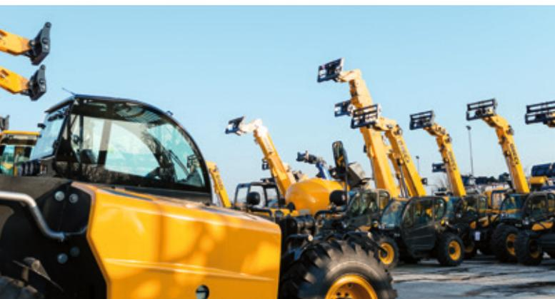
La chargeuse télescopique sur roues Dieci la plus puissante est employée dans le monde entier par des entreprises du secteur de la construction. Des forces extrêmement élevées sont exercées sur le châssis des chargeuses sur roues – avec une charge de transport maximale de 14 tonnes.
