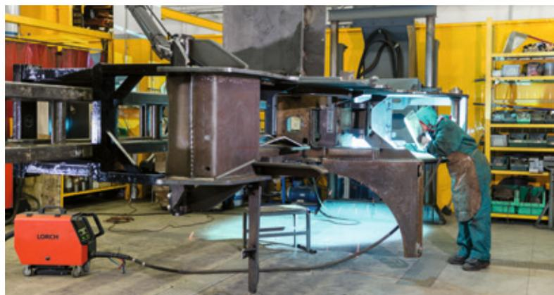
Idéal pour les grands composants : avec le régulateur à distance Powermaster, les paramètres de soudage se règlent directement sur la torche.
