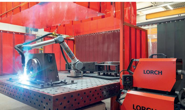
En el ámbito de la soldadura, todo el parque de máquinas está conectado con Lorch Connect, incluido el Cobot de soldadura de Lorch, que se utiliza sobre todo para soldar eficazmente turbinas de acero al manganeso.
