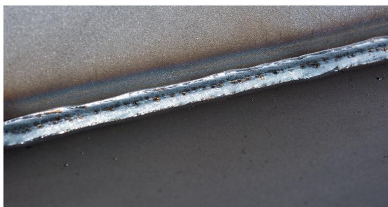
Cordones de soldadura de alta calidad: Las uniones también ofrecen un aspecto de soldadura óptimo. Las áreas difíciles como las zonas de punteado y los huecos desiguales se pueden soldar fácilmente con SpeedPulse XT.
