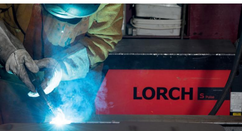
Muy útil además del nuevo proceso de soldadura SpeedPulse XT: la regulación dinámica. Esta permite a los soldadores establecer un arco más suave o más duro según el proceso de trabajo o las preferencias personales.
