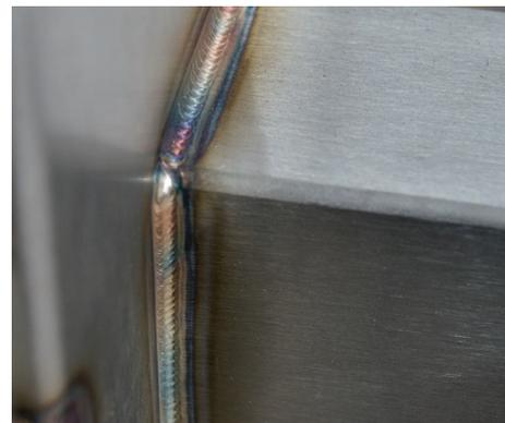
Los mejores cordones de soldadura: Para evitar la corrosión o los microbios, los cordones de soldadura no deben tener hendiduras ni poros.
