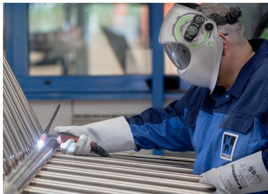
La aportación de energía se puede controlar con absoluta precisión con la T-Pro, lo cual es sumamente importante cuando se sueldan láminas delgadas.
