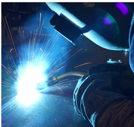
SpeedArc no solo permite a Mecalfast soldar más rápidamente el acero especial Weldom. El proceso de soldadura también garantiza un cordón de soldadura preciso, limpio y con poca distorsión.
