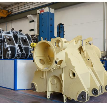
Gracias a la gran resistencia del acero especial Weldom, se pueden fabricar componentes como estos chasis de menor peso.
