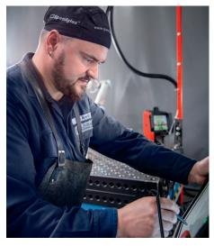
Sencillo: El proceso de soldadura se "programa" a través de la pantalla táctil. Alternativamente, la antorcha se puede mover manualmente a la posición inicial y final utilizando la función Free-Drive.
