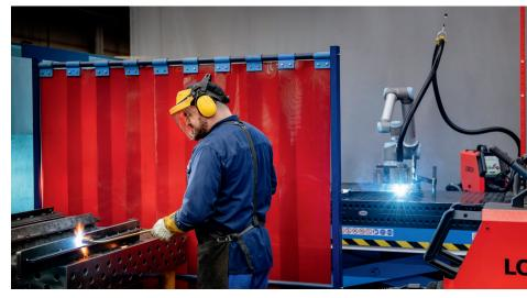
Ahorro de tiempo: Mientras que el Cobot de Lorch realiza con precisión los cordones de soldadura establecidos para una pieza recurrente, el soldador ya está preparando la siguiente pieza para la soldadura.
