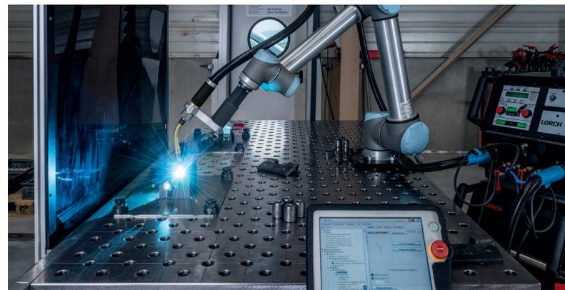
Punto positivo de la gran longitud del brazo del UR 10: Mientras el cobot suelda en un dispositivo, la siguiente pieza de trabajo se puede colocar en un segundo dispositivo en la mesa de trabajo.
