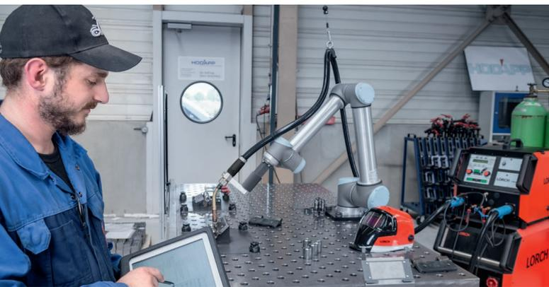
Programación sencilla: Con el software Cobotronic de Lorch se pueden introducir rápidamente los parámetros de soldadura necesarios, como el grosor de la chapa, el material y el espesor de garganta "a".
