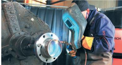
Luis Braga suelda la pasada de raíz del soporte de tubería con un sistema S-SpeedPulse de Lorch utilizando el proceso SpeedRoot de Lorch. La pasada superior se suelda con SpeedPulse de Lorch.
