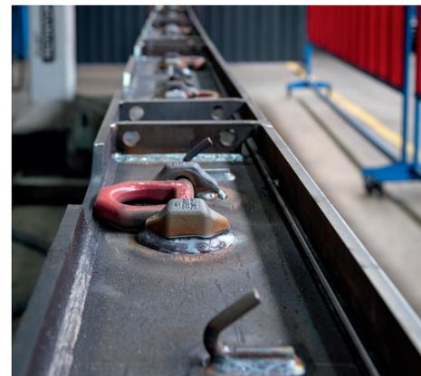
La MicorMIG muestra sus puntos fuertes en Faymonville: penetración profunda, número reducido de pasadas y tiempo de soldadura corto.
