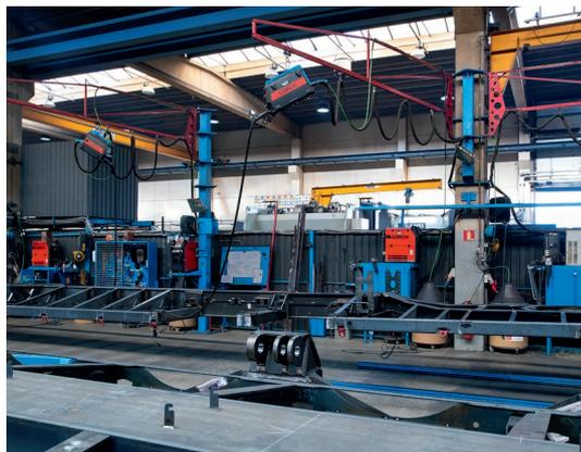
Más de 160 MicorMIG 400 ya están trabajando en las cinco fábricas del Faymonville Group. El inverter de soldadura MIG-MAG destaca con el proceso SpeedArc para un arco focalizado, alta velocidad de soldadura y una guía de operador simple y en varios idiomas.
