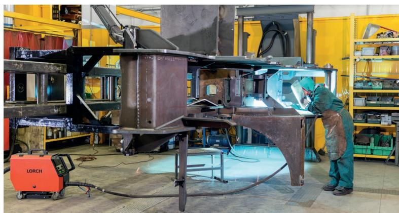
Ideal para grandes repuestos: Con el control remoto Powermaster, los parámetros de soldadura se pueden configurar directamente en la antorcha.
