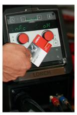
Muy útil en el proceso de fabricación: Las curvas características almacenadas en tarjetas NFC se pueden leer rápidamente y sin contacto en todos los sistemas
