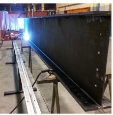
Schnell und einfach programmiert: Der Trac RL Pro entlastet Schweißer und sorgt für exzellente Längs- und Kurvennähte.
