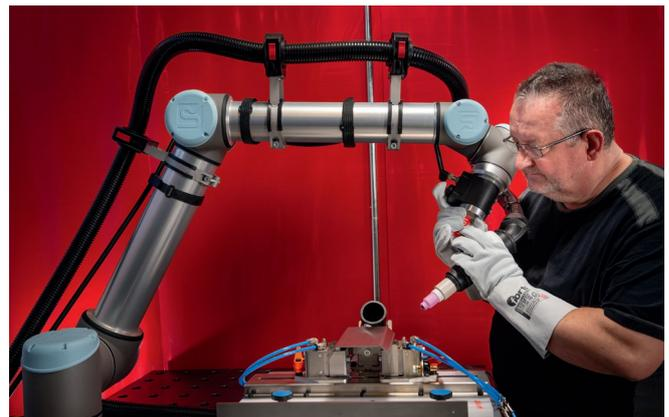
Die Free-Drive-Funktion befindet sich für den Schweißer sehr gut zugänglich direkt an der Brennerhalterung.
